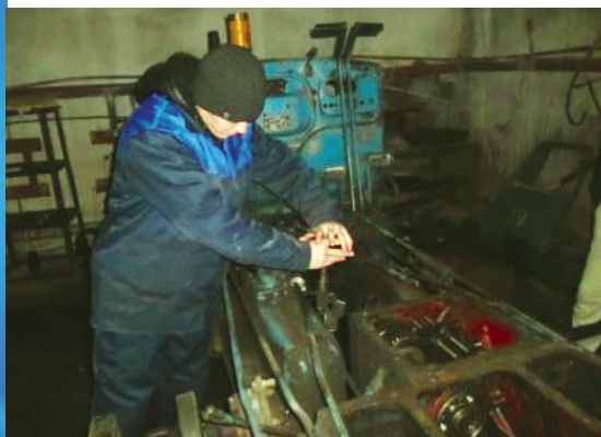
На фото: разборка двигателей крупных сельскохозяйственных машин
